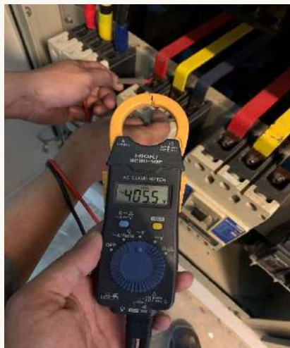
ทำการจ่ายไฟคืนระบบและทดสอบการใช้งาน
