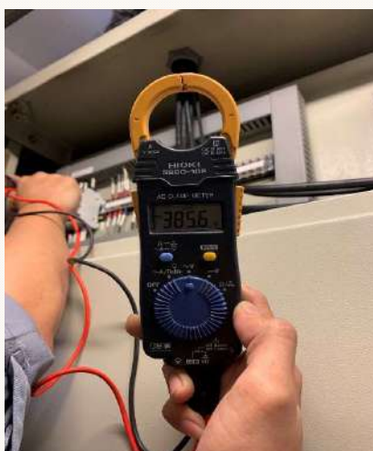
ทำการจ่ายไฟคืนระบบและทดสอบการใช้งาน
