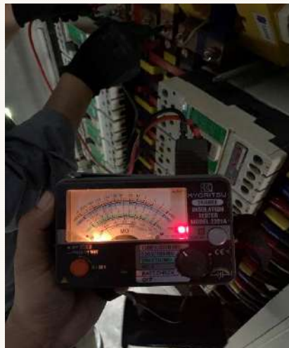
ทำการตรวจเช็คความเรียบร้อยภายในตู้ และวัดค่าความต้านทานของฉนวน MEGGER OHMS
