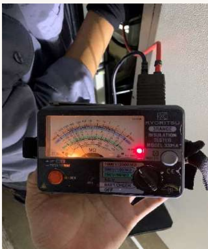
ทำการตรวจเช็คความเรียบร้อยภายในตู้ และวัดค่าความต้านทานของฉนวน MEGGER OHMS
